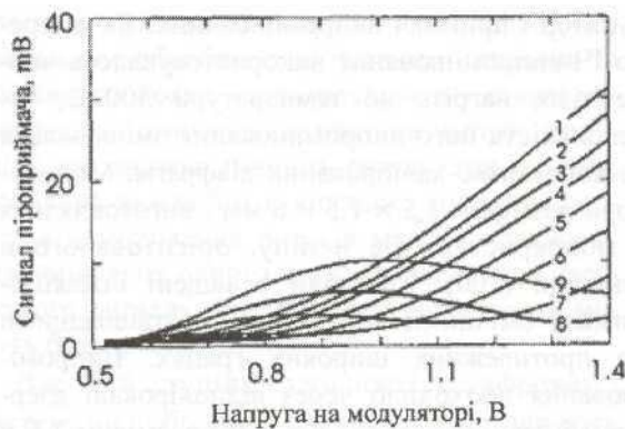
Рис. 3. Залежності амплітуд сигналу приймача випромінювання від величини напруги керування модулятора за різних діаметрів вихідного отвору чорного тіла (у мм): 1-0; 2-3; 3-4; 4-5; 5-6; 6-7; 7-8; 8-9; 9-10
