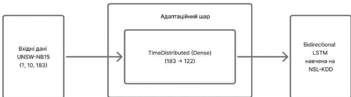
Рис. 43 – Адаптаційна архітектура Bidirectional LSTM для UNSW-NB15
