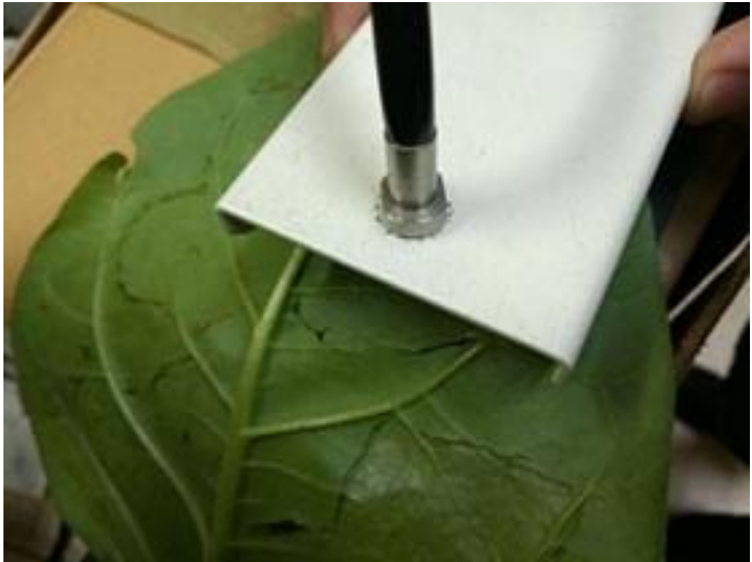
Рис.2.3. Зображення виносного аналізатора спектрофлуориметра «Флюорат-02 ПАНОРАМА»
