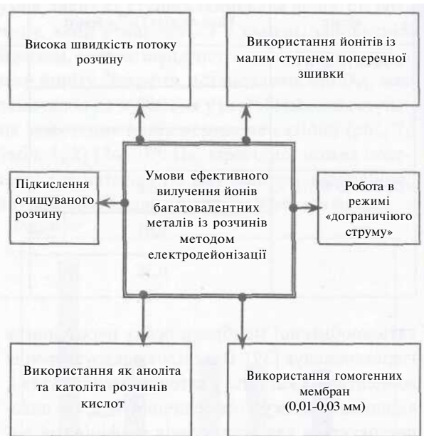
Рис. 9. Фактори, що сприяють підвищенню електродейонізаційного вилучення катіонів важких металів із розбавлених розчинів
