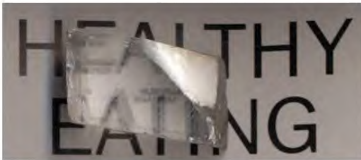
Рис. 1.7. Подвійне заломлення світла в кристалі кальциту.
