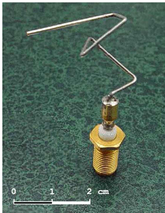
Рисунок 2.2.3 – еволюційна антена, винайдена еволюційним алгоритмом NASA
