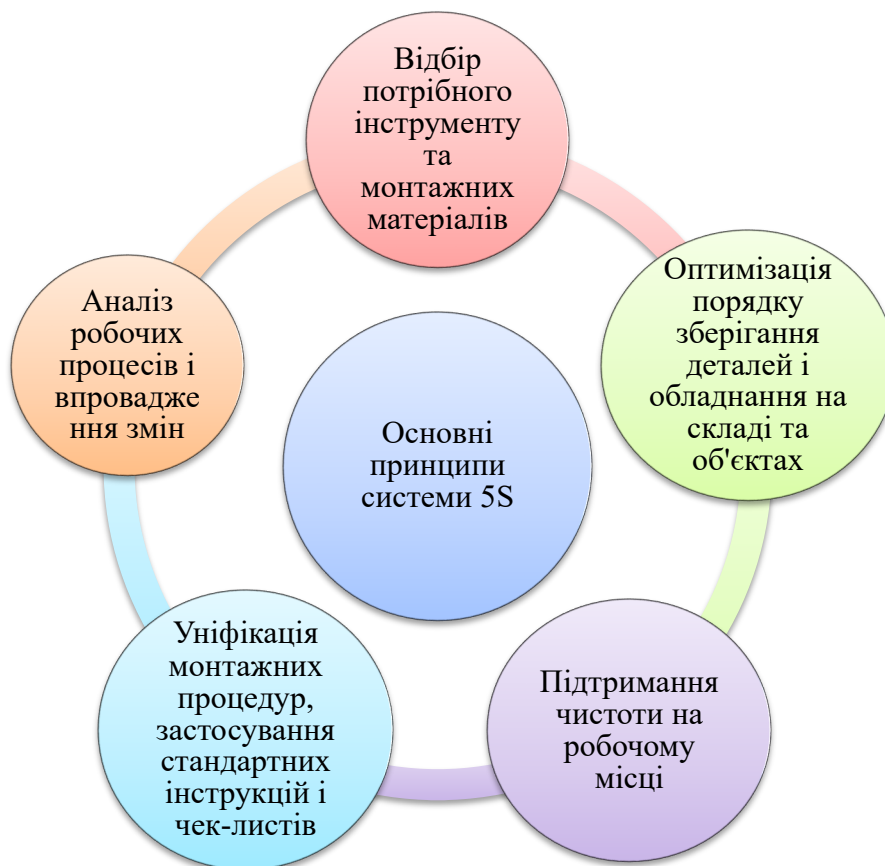
Рис. 3.2 Основні принципи системи 5S для ТОВ «Монтаж-Сервіс Бруннер» (нім. Montage-Service Brunner GmbH)
