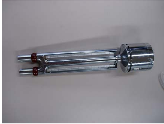
Рис. 8.1. Аспіраційний психрометр Асмана: а – конструкція психрометра; б – зовнішній вигляд
