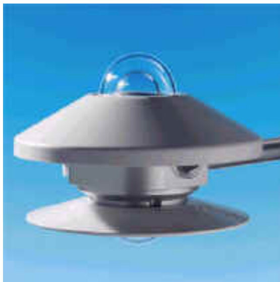
Рис. 10.11. Зовнішній вигляд альбедометра
