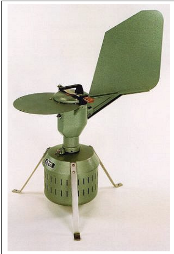
Рис. 20.2. Зовнішній вигляд приладу для збору біоаерозолів
