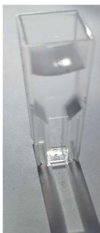
Рис. 2.13. Розчин наночастинок ZnO , виготовлений методом колоїдного синтезу.
