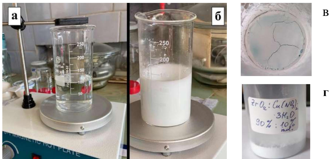
Рис.5.1.1 (а) розчин нітрату міді у дистильованій воді, (б) розчин після додавання до нього порошку діоксиду цирконію, (в) вигляд матеріалу після випаровування води, (г) порошок після висушування та перетирання.
