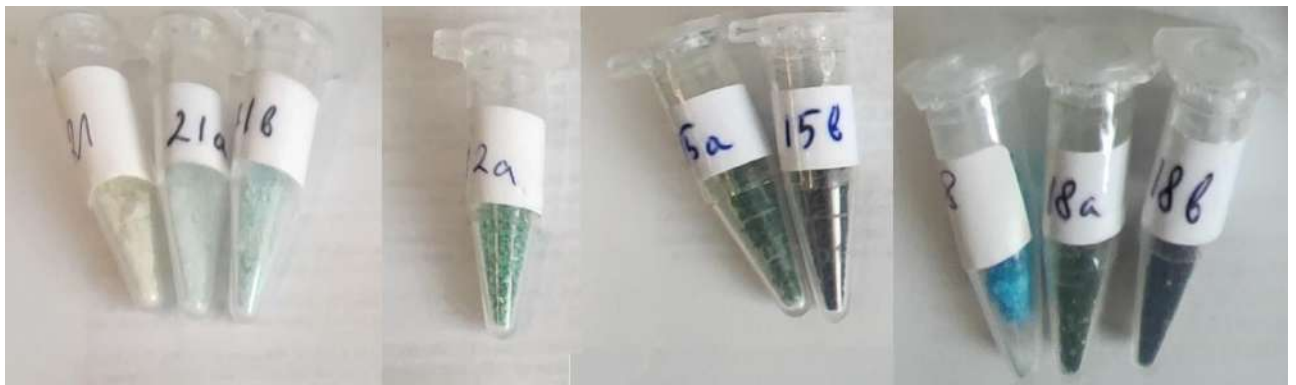
Рис. 5.3.2 Порошки на основі оксиду цирконію, леговані міддю з вмістом 0,1 мол.% (№ 21), 1 мол.% (№12), 5 мол.% (№ 15) та 8 мол.% (№18), до відпалу (№21 та № 18) та після відпалу при 600 °С ( позначені додатково «а») та 800 (позначені додатково «в»).
