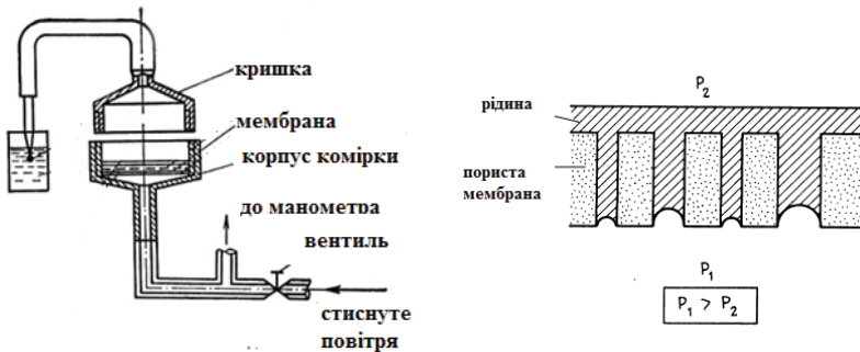
Рис. 55. Установка для визначення пор найбільшого діаметра методом появи бульбашки
