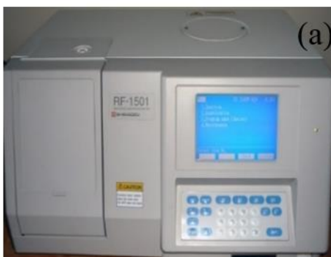
Рис. 2.0. Фото спектрофлуориметра SHIMADZU RF-1501.
