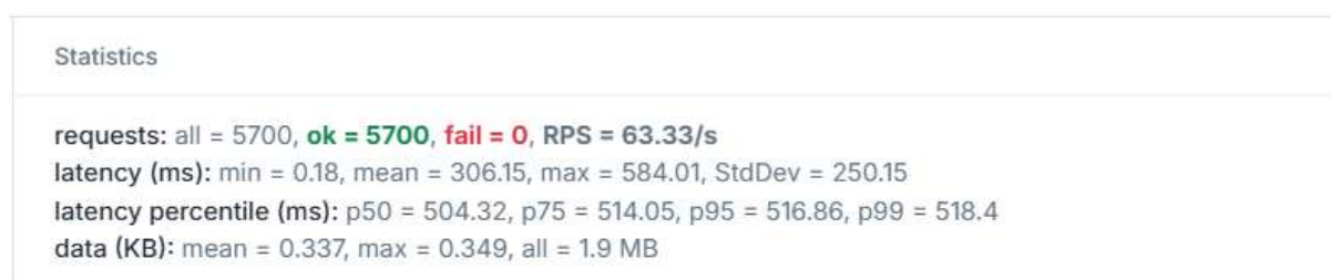
Рис. 3.9. Результати стрес-тестування системи (сценарій Spike Load)
