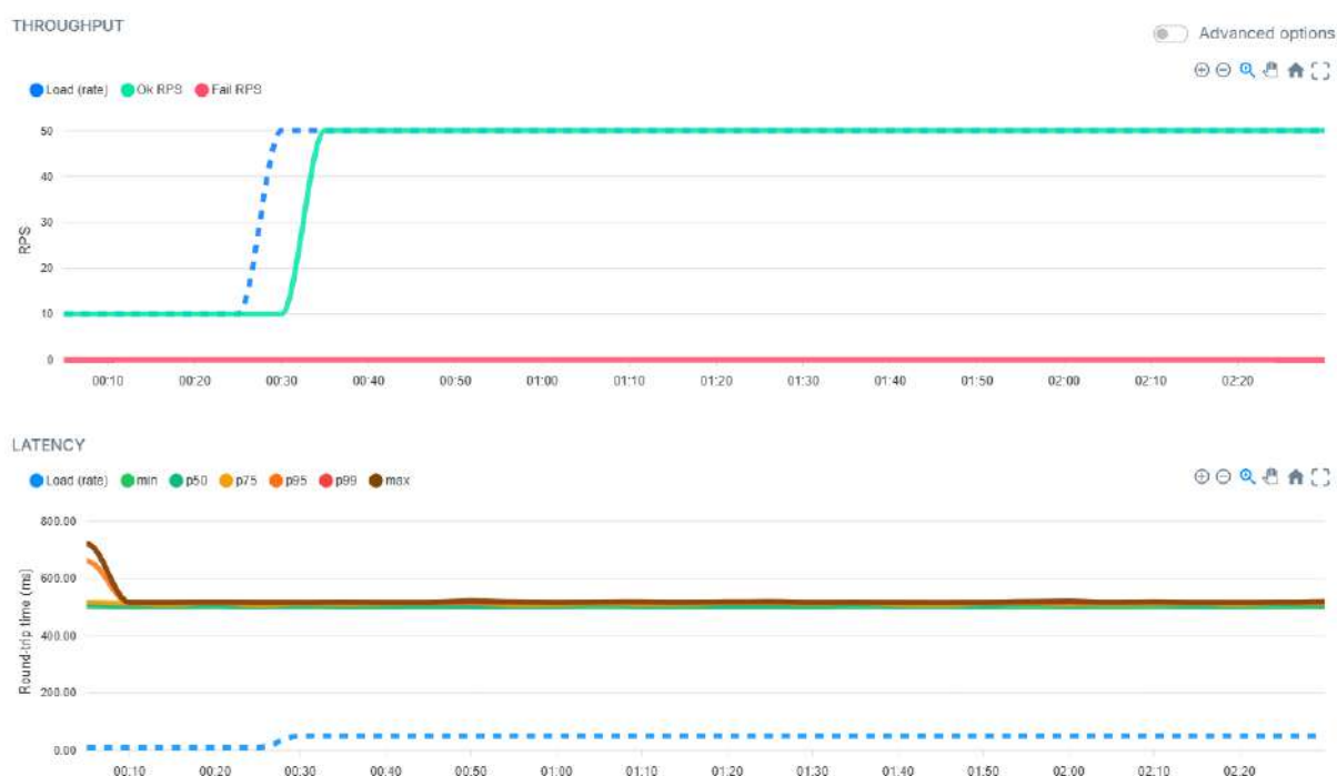
Рис. 3.4. Графіки пропускної здатності та затримок базового тесту
