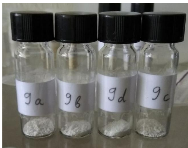
Рис.4.1.3 Леговані ітрієм порошки на основі оксиду цирконію ( Y_2O_3 - ZrO_2 (20 мол%)) синтезовані за різної температури спікання: (9a) – 400^{\circ}C , (9b) – 500^{\circ}C , (9c) – 600^{\circ}C , (9d) – 700^{\circ}C .
