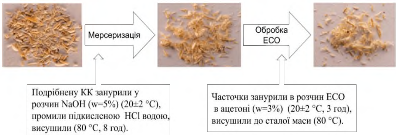
Рис. 2.1. Схема процесу модифікування конопляної костриці
