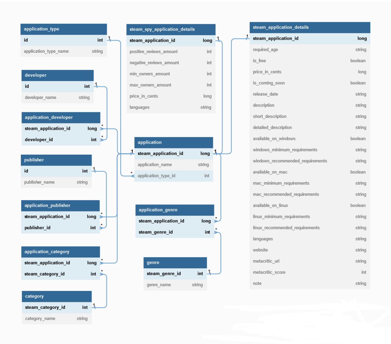
Рисунок 4.2.1. Схема бази даних
