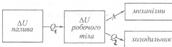
Рис. 3.9. Схема зміни внутрішньої енергії та каналів її перетворень при роботі теплової машини
