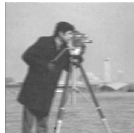
Рис. 4. Відновлення зображення спотвореного розмиттям у русі й білим шумом з \text{SNR}=30 дБ регуляризацією повної дисперсії.
