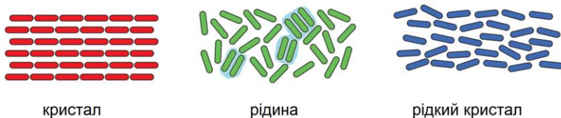
Рис. 2.3. Схеми просторової будови кристалу, рідини або твердої аморфної речовини та рідкого кристалу.
