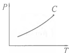
Рис. 5.4. Температурна залежність тиску насиченої пари – проекція двофазної області рідина-газ на координатну площину P, T
