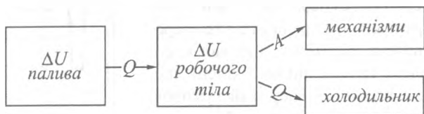
Рис. 1.14. Схема зміни внутрішньої енергії та каналів її перетворень при роботі теплової машини
