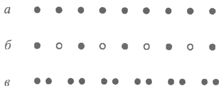
Рис. 6.2. Лінійні моделі кристалічної структури: а – проста ґратка, де однакові частинки однаково розташовані одна відносно другій; б – складна ґратка, яка утворена з частинок різного сорту; в – складна ґратка, яка утворена з однакових частинок, кожна з яких розташована не еквівалентно відносно сусідніх частинок.
