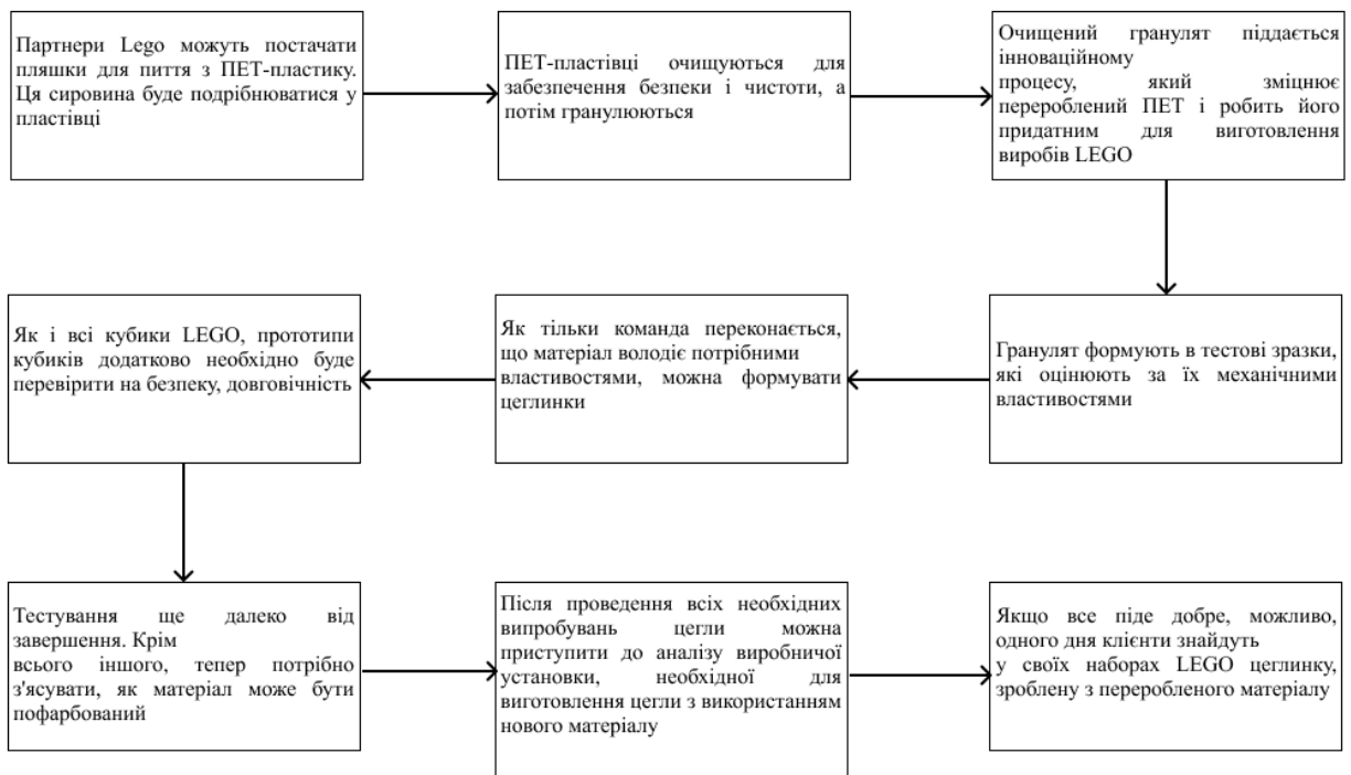
Рис. 3.1 Прототип рішення використанням перероблених пляшок у виробництві
