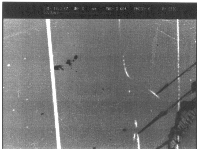
Рис. 1.18. Зображення поверхні кристала CdS з \alpha_1 = 1,1 , одержане за допомогою методу струмів, індукованих електронним зондом (ЕВІС) (збільшення 4000)
