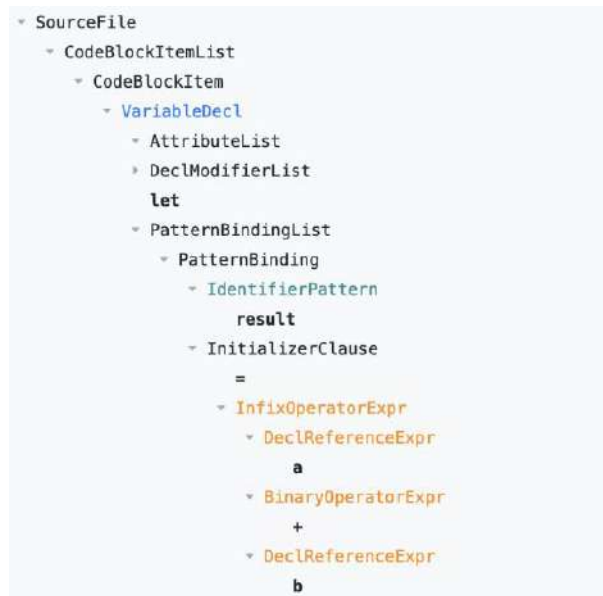
Рис. 1.3. Приклад представлення коду у вигляді синтаксичного дерева
