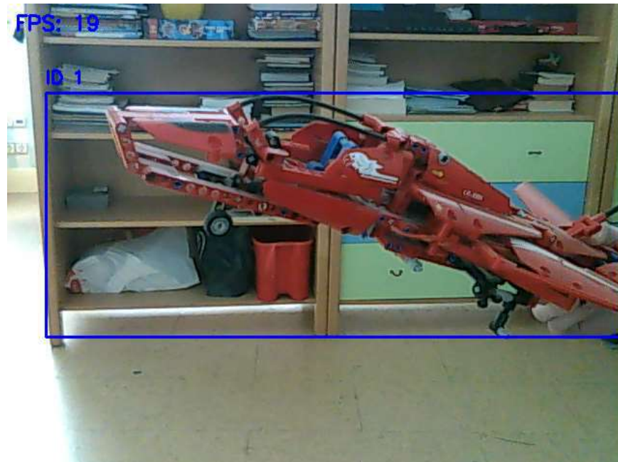
Рис. 3.9 Камера, YOLO детектор, трекер OC-SORT Робота на великому об'єкті
