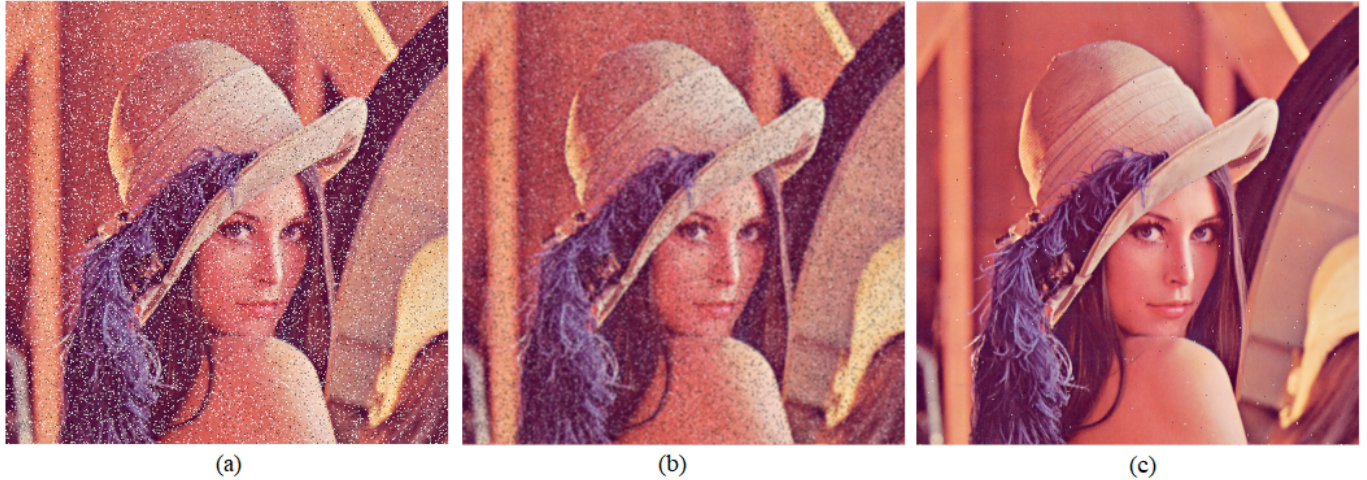
Рисунок 4.2 (a) — зображення з 10% шуму, (b) — результат роботи Vox Blur, (c) — результат одного кроку клітинного автомата
