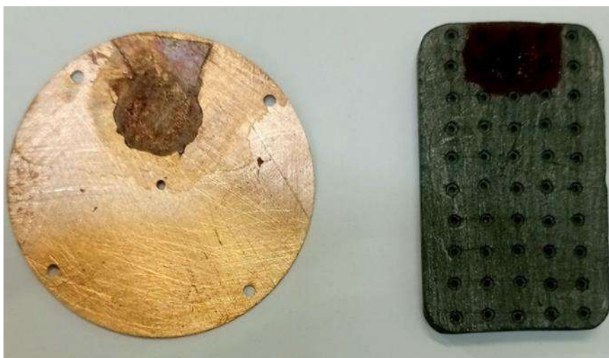
Рис. 3.6. Композитна плівка \alpha\text{-Fe}_2\text{O}_3/\text{PEDOT:PSS} на мідній фользі та графітій основі.
