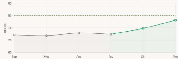
Рисунок Б.2 — Динаміка OEE механічного цеху до та після впровадження цифрового двійника
