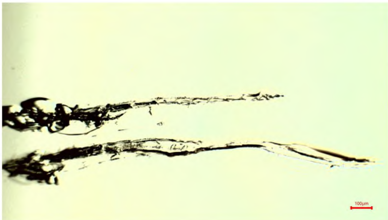
Рис. 3.26. Порівняння абразивності незмоченої композиції з контрольною подряпиною
