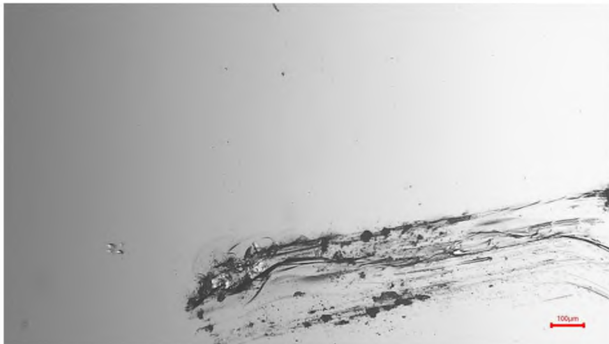
Рис. 3.27. Порівняння абразивності композиції, змоченої водою, з контрольною подряпиною
