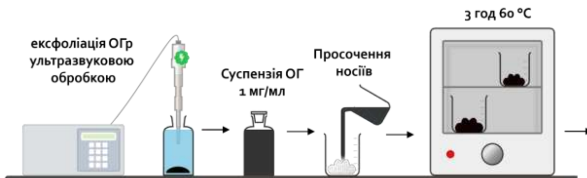
Рис. 2.2 Схема синтезу зразків з нанесеним ОГ на оксидні носії
