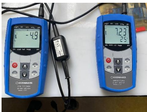
Рис. 2.1. рН- і RedOx–метр «Greisinger GMH 5530»
