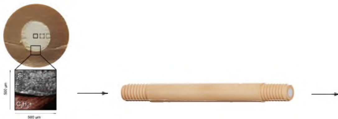
Рис 2.5. Пористий кремнеземний моноліт після кледдінгу в розрізі та загальний вигляд [4]
