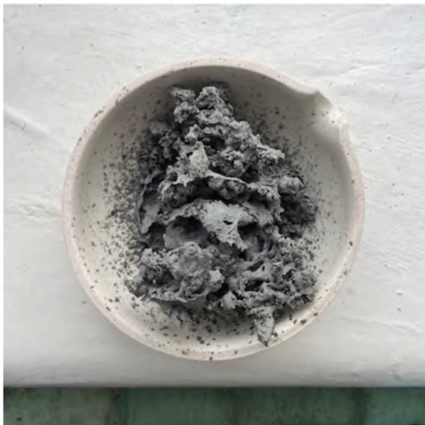
Рис. 2.1. Отриманий каталізатор Ni/CaO після прожарювання у муфельній печі протягом 5 годин за температури 700°C.
