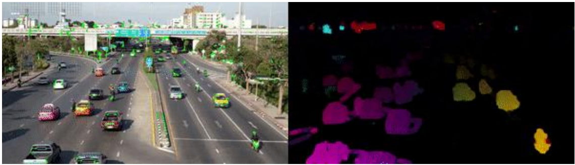
Рисунок 3. Порівняння роботи Sparse (зліва) і Dense (праворуч) оптичних потоків
