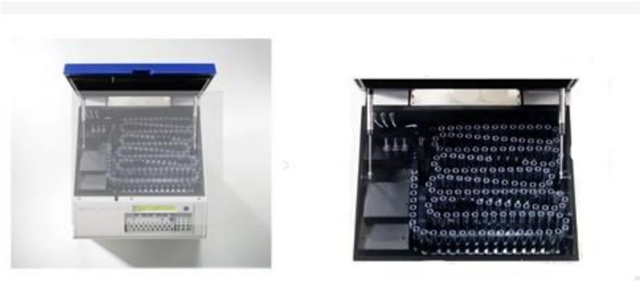
Рис. 2.5. Автоматичний люмінометр Autolumat LB 953 – вигляд зсередини.
