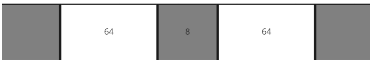
Рисунок 1 Два вільних блоки у 64 байти розділені блоком у 8 байт. Незважаючи на те, що буфер має 128 байт вільної пам'яті, максимальний розмір блоку, який може бути виділений - 64 байти
