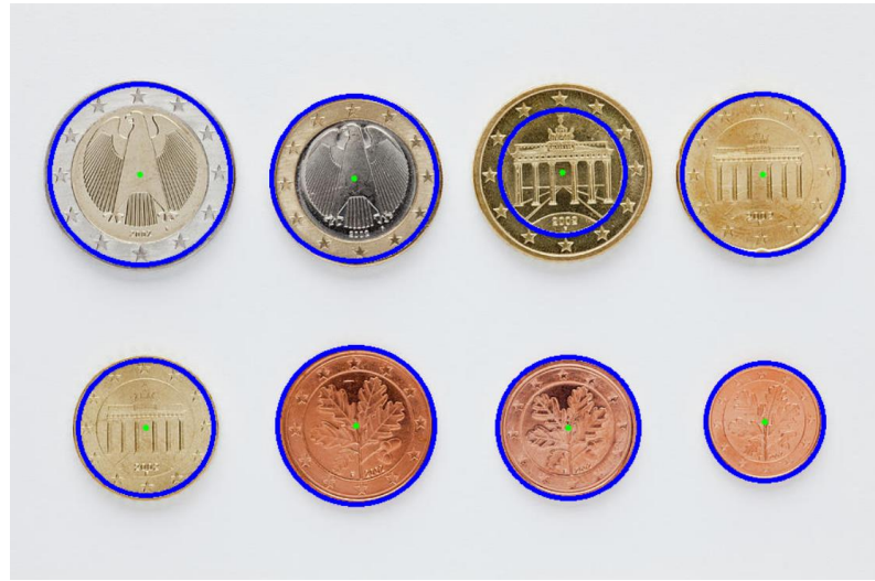
Рисунок 3.6 – результат застосування функції HoughCircles зі значенням параметру method = HOUGH_GRADIENT на початковому зображенні.
