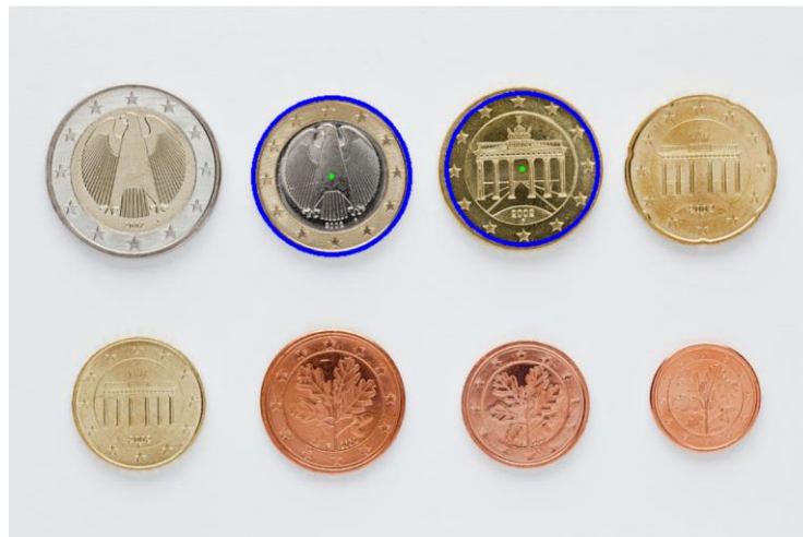
Рисунок 4.4 – Результат застосування функції HoughCircles на початковому зображенні.
