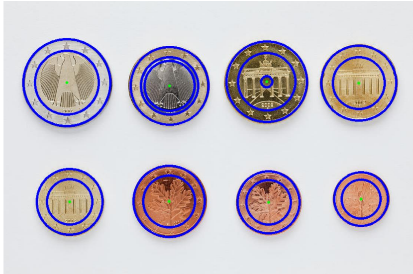
Рисунок 3.11 - результат застосування функції HoughCircles зі значеннями параметрів method = HOUGH\_GRADIENT\_ALT та param2 = 0.8 на початковому зображенні.
