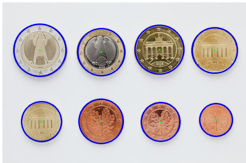
Рисунок 3.10 - результат застосування функції HoughCircles зі значенням параметру method = HOUGH_GRADIENT_ALT на початковому зображенні.
