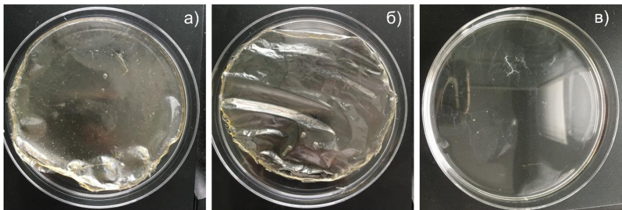
Рис. 4.2. Зовнішній вигляд сформованих плівок після висушування: а) АС-KBr-2:1, б) АС-KBr-1:1, в) АС-KBr-1:2
