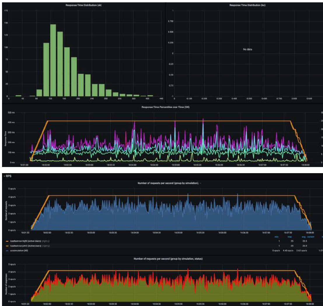
Рисунок 3.1.5 – Час відгуку та пропускна здатність під час тесту
