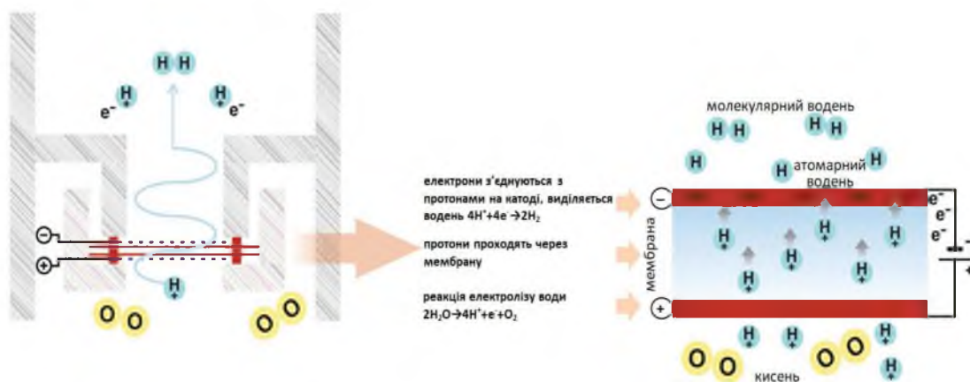
Рис.1.1. Схема протонпровідної мембрани
