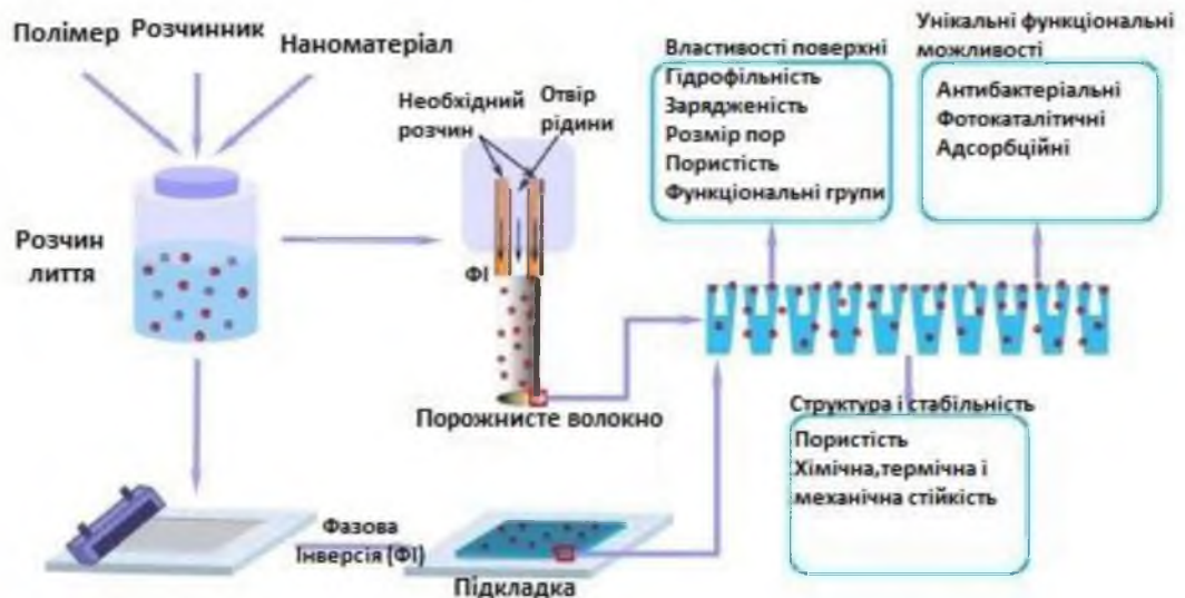
Рис. 1.2. Виготовлення нанокомпозитних мембран методом інверсії фаз
