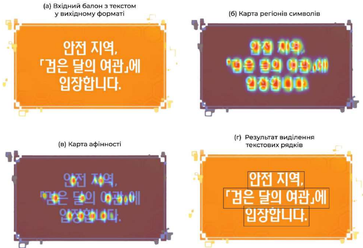
Рисунок 2.7 – Візуалізація роботи CRAFT на прикладі балону манхви:
