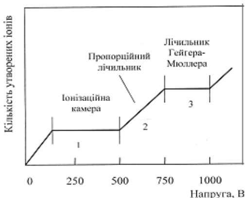
Рис. 30.2. Області дії заповнених газом детекторів: 1 – іонізаційна камера; 2 – пропорційний лічильник; 3 – лічильник Гейгера-Мюллера
