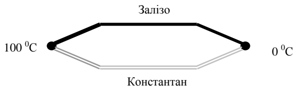
Рис. 8.6. Замкнутий ланцюг, що складається з двох різнорідних провідників, контакти яких мають різні температури
