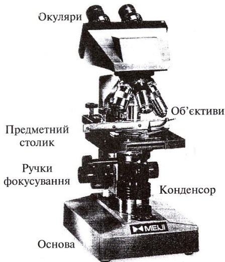
Рис. 20.8. Зовнішній вигляд сучасного мікроскопа
