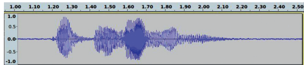
Мал. 9. Діаграма сигналу вимовленого слова «технологія» (для запису використано програму Audacity)
