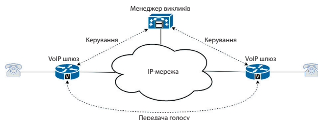
Мал. 11. Передача голосу та керування викликами в мережі IP-телефонії
