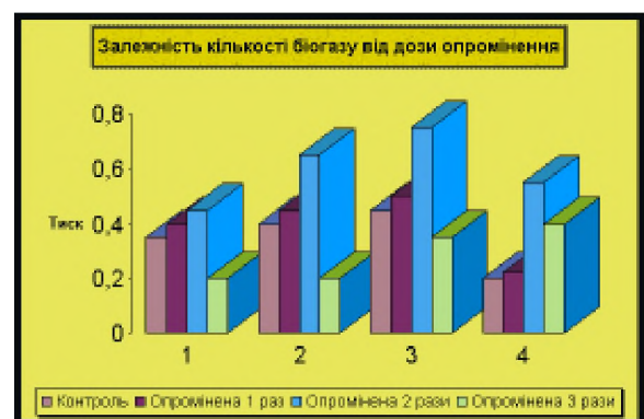
Графік 1. Кількість біогазу (тис. кг/см 2 ), виділеного метаногенною асоціацією мулу очисної станції в залежності від періодичності і тривалості (по 20 хвилин) високочастотного опромінення (11,6 ГГц) за добу на початку культивування мікробів
