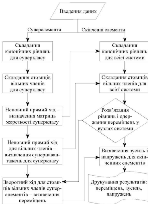
Рис. 2. Загальна схема автоматизації розрахунку системи споруда-основа методом скінченних елементів та суперелементів
